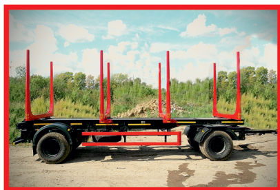
Прицеп 6-8-метровый, 2-осный, 2-скатный. Оси – 12 т, рессоры – 12 т. Полная масса – 18 т.
