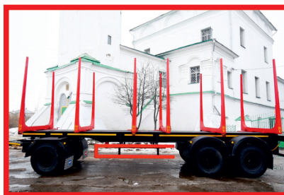
Прицеп 8-метровый, 3-осный, 2-скатный. Оси – 12 т, рессоры – 12 т. Полная масса – 24 т.
