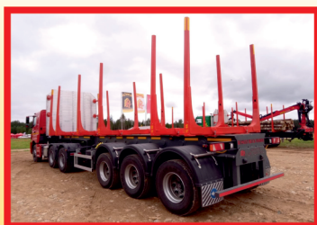
Полуприцеп 12,5-метровый, 3-осный, 2-скатный. Оси – 12 т, рессоры – 12 т. Полная масса – 40 т.
