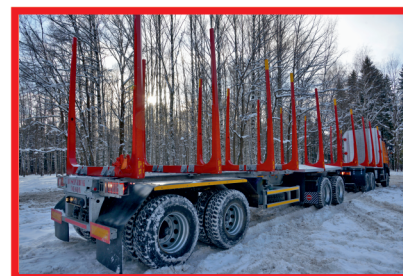
Прицеп 8-метровый, 4-осный, 2-скатный. Оси – 12 т, рессоры – 12 т. Полная масса – 36 т.
